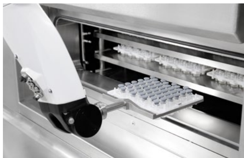
Sistema robótico para o carregamento de frascos-ampola em Nest.
